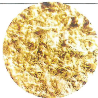
■ウラゴメール混入モルタルの拡大写真(約10倍)
